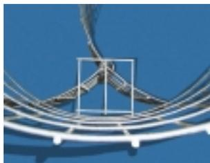
Bodengitter: verhindert das Durchfallen der Füllmaterialien bei mehreren Lagen übereinander in versetzter Bauweise
