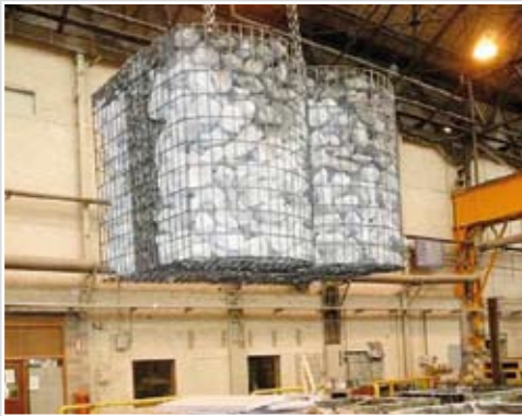
Prototyp der werksbefüllten FERRONDO®-Gabione, Ausführung als Doppelkorb, mit Holzspanbeton als Kernfüllung.
